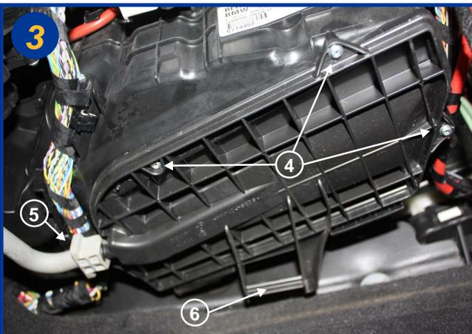
Dévisser les 3 vis Torx (T20) de fixation du couvercle du boîtier filtrant (4), il n'est pas nécessaire de retirer l'indicateur de colmatage (5). Retirer le couvercle à l'aide de la poignée (6).
