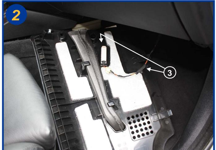
Dégrafer et débrancher le connecteur du plafonnier de la boîte à gants (3). Extraire dans sa totalité le carter.
