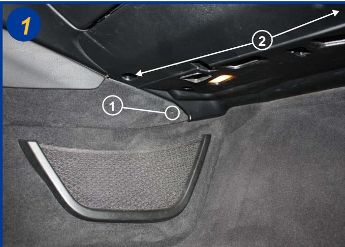
Les filtres d'habitacle sont situés à l'intérieur du véhicule coté passager sous la boîte à gants. Dévisser la vis Torx (T20) (1) et dégraffer en partie la garniture. Dévisser les 2 vis Torx (T20)(2) et déboîter le carter sous la boîte à gants.
