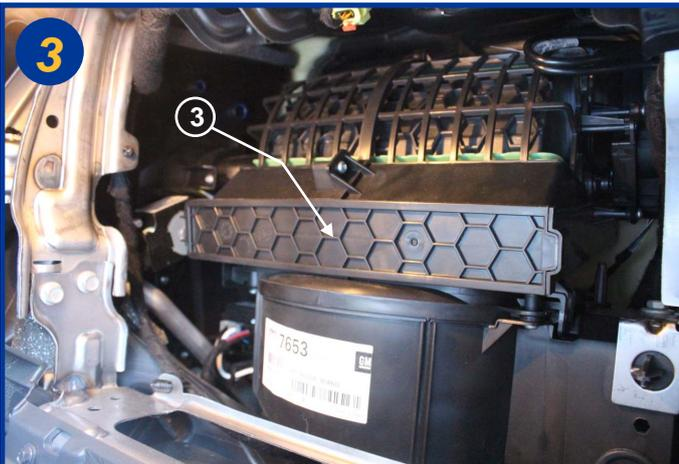
Ouvrir le boîtier filtrant (3) en agissant sur le fermetoir situé à gauche.
