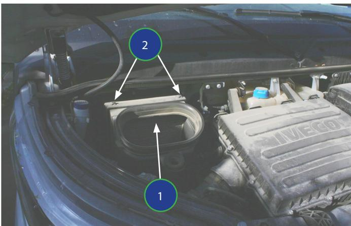
1. Le filtre d'habitacle est situé à l'avant sous le capot moteur (1)
