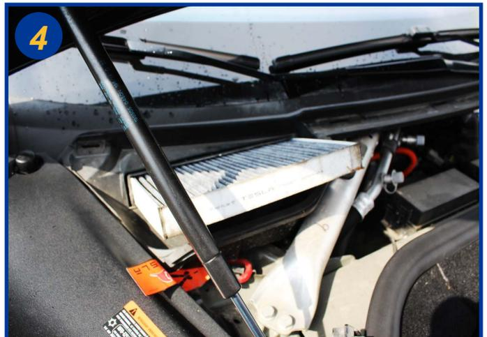
Remplacer le filtre usagé par un filtre neuf. Le remontage s'effectue dans l'ordre inverse du démontage. Le remplacement de cette pièce ne nécessite aucun outil.
