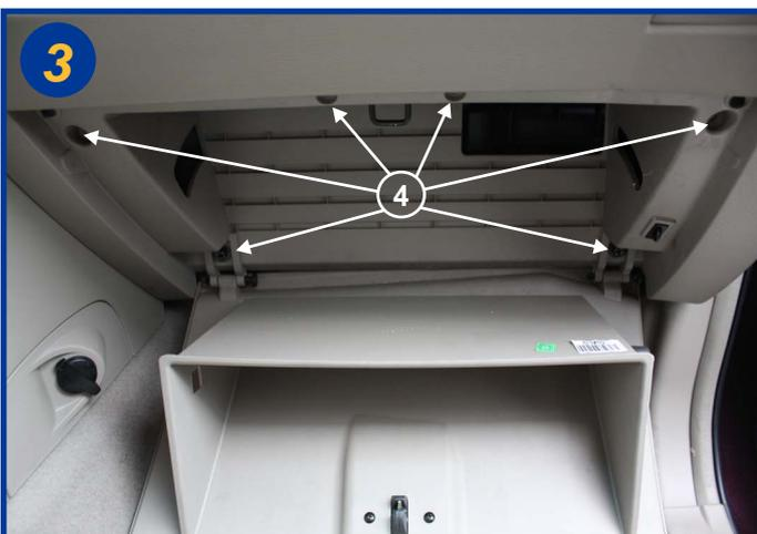
Dévisser les 6 vis cruciformes (4) et écarter l'ensemble boîte à gants (il n'est pas nécessaire de la retirer totalement).
