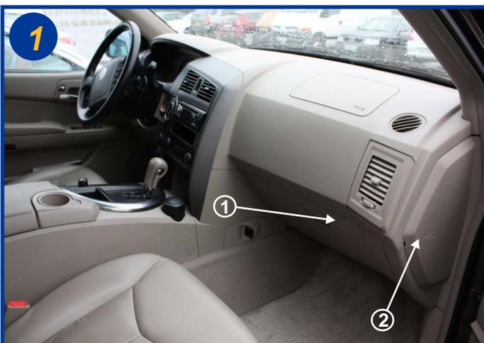
Les filtres d'habitacle sont situés à l'intérieur du véhicule, coté passager derrière la boîte à gants (1). A l'aide d'un tournevis, retirer le flanc droit (2) de la planche de bord.
