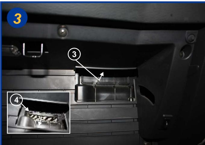
Retirer le couvercle du boîtier filtrant en agissant sur le fermoir situé sur la partie supérieure (3).
