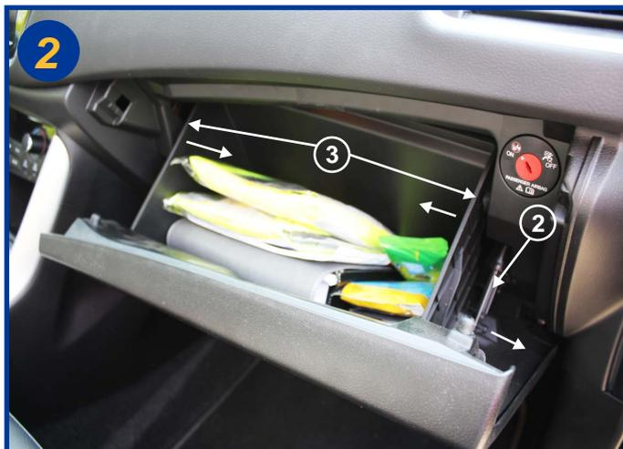
Retirer le tirant de l'amortisseur de boîte (2) dans le sens de la flèche, presser sur les flancs du tiroir pour dégager les arrêteurs (3). Extraire la boîte à gants en la sortant de ses charnières et la poser au sol.
