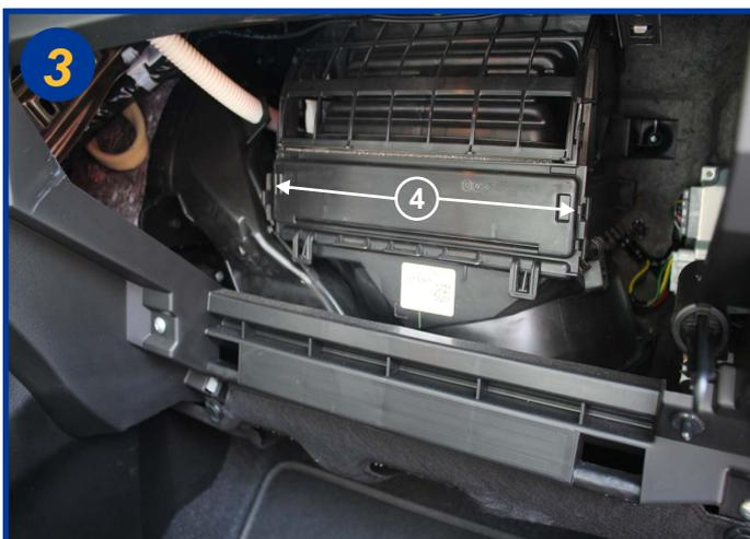
Ouvrir le boîtier filtrant en actionnant les 2 fermoirs (4) dans le sens des flèches. Retirer le couvercle.
