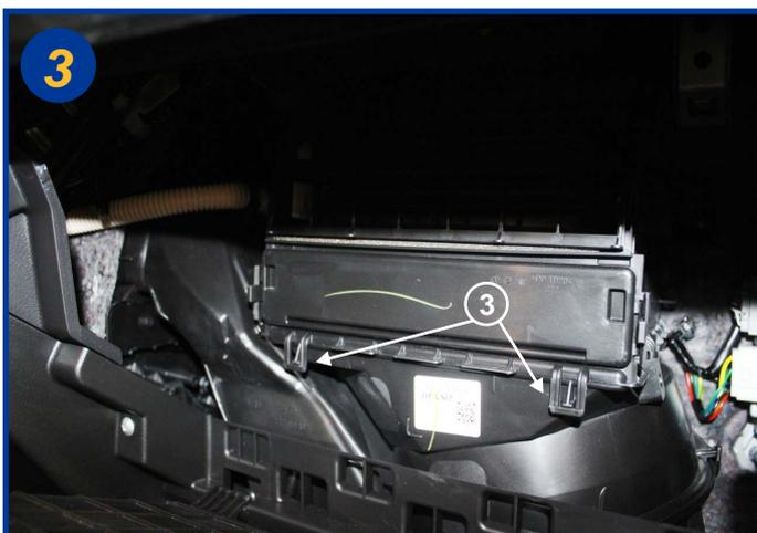
Ouvrir le boîtier filtrant en agissant sur les 2 fermoirs (3).
