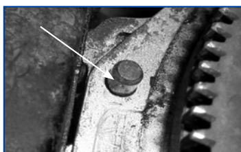
Desgaste de las guías centradoras de la caja de cambios (faltan o dañadas)
