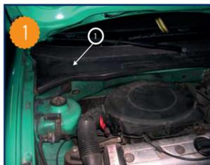
1 Le filtre d'habitacle est situé sous le capot moteur, sur labaie du pare-brise coté passager (voir flèche 1). Ouvrir le capot moteur.
