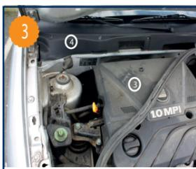
Retirer sur la moitié, le joint d'étanchéité du capot moteur (3) et extraire le carter (4) dans sa totalité.
