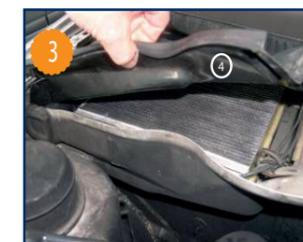
Soulever le cache protégeant le filtre (il n'est pas nécessaire de le retirer totalement). Décliper les 2 pattes de fixation du filtre sur son boîtier (flèche 4)
