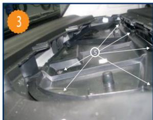
3 Dévisser les 6 vis de fixation du cache plastique (voir flèche 5) et retirer ce cache.
