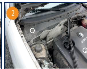
Retirer sur la moitié le joint d'étanchéité du compartiment moteur (2). Puis retirer également le carter de protection sous la baie du pare brise (3) (aucun outil n'est nécessaire pour accomplir cette action).
