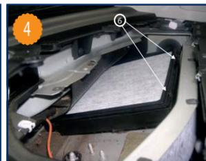
4 Dégager l'élément filtrant de son cadre en actionnant les 2pattes de fixation (flèche 6) et le remplacer. Le remontage s'effectue dans l'ordre inverse du démontage.
