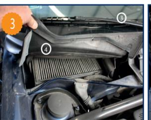
Soulever le carter souple et le maintenir ouvert (3), et basculer les 2 attaches plastiques (4) afin de retirer l'élément filtrant et son cadre.
