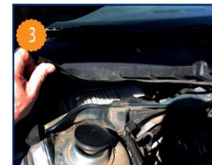
3 Soulever le cache plastique pour avoir accès à l'entrée du climatiseur. Retirer le filtre habitacle usagé ainsi que son cadre de maintien en le déclipant à l'aide des 2 pattes situées sur le devant du boîtier.
