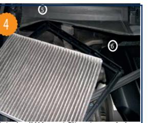
Extraire l'élément filtrant usagé de son cadre (flèche 5). Le remplacer en veillant à ce que les deux premiers plis aux extrémités du filtre soient engagés dans les bordures prévues à cet effet (voir flèche 6). Le remontage s'effectue dans l'ordre inverse du démontage
