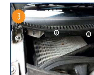
Retirer ensuite le déflecteur (3) pour avoir accès aux 2 fermoirs, agir sur ceux-ci pour dégager le filtre et son cadre. Les 2 fermoirs sont situés au niveau des flèches (4).
