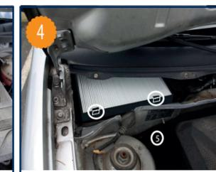
Basculer vers l'extérieur les 2 petites pattes (5) de maintien et procéder au remplacement du filtre. Le remontage s'effectue dans l'ordre inverse du démontage.
