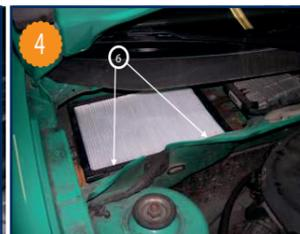
4 Dissocier l'élément du cadre en actionnant les deuxpattes (repère 6) et changer l'élément. Repositionner le cadre à sa place. Le remontage s'effectue dans l'ordre inverse du démontage
