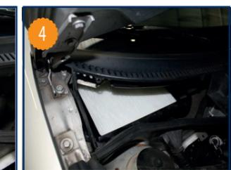
Replacer le filtre neuf dans son cadre, imbriquer les 2 premiers plis dans les nervures prévues à cet effet. Le remontage s'effectue dans l'ordre inverse du démontage.
