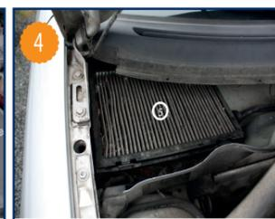
Actionner les 2 pattes de fixation (5) pour retirer le filtre usagé et son cadre, remplacer le filtre et le reloger dans son cadre. Le remontage s'effectue dans l'ordre inverse du démontage.
