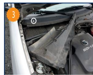
Retirer sur la moitié, le joint d'étanchéité du capot moteur (3) et extraire le carter (4) dans sa totalité.
