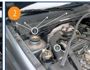
2 Retirer sur la moitié, le joint d'étanchéité moteur (repère 2) Déclipser ensuite le cache (repère 3).
