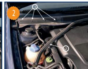
2 Retirer sur la moitié, le joint d'étanchéité moteur (repère 2) Dévisser ensuite les 4 vis de maintien du cache (repère 3).
