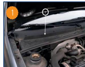
1 Le filtre d'habitacle est situé sous la baie de pare-brise, coté passager sous le capot moteur (repère 1). Ouvrir le capot moteur.
