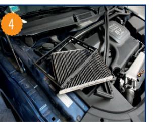
Retirer l'élément filtrant usagé de son cadre et remplacez le en imbriquant les 2 premiers plis dans les bordures du cadre. Le remontage s'effectue dans l'ordre inverse du démontage.
