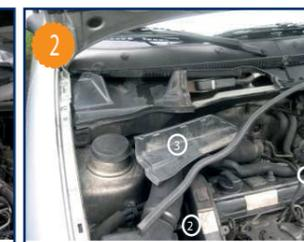
Retirer le joint d'étanchéité du compartiment moteur (2) retirer également le cache d'accès au moteur d'essuie glace (3)
