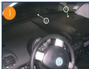
1 Le filtre à air d'habitacle est situé à l'intérieur du véhicule sur la planche de bord coté passager. (voir flèche 1) Faire coulisser le cache plastique vers le pare brise (2) et le retirer.
