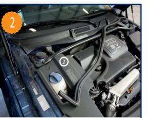
Retirer la quasi-totalité du joint d'étanchéité du compartiment moteur (2).
