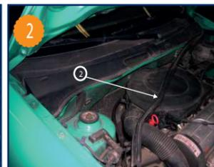
2 Retirer le joint d'étanchéité moteur sur la moitié (flèche 2).
