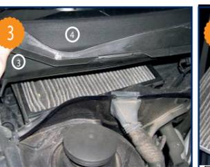
Décliper l'élément filtrant et son cadre (flèche 4) en maintenant ouvert le volet (3).
