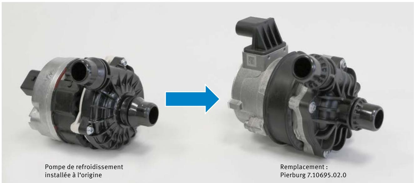
Pierburg a développé pour les véhicules électriques à batterie (BEV) une pompe de refroidissement spéciale du type CWA 100-4. Dans la Mercedes-Benz EQC, pas moins de deux de ces pompes assurent de série la gestion thermique. Toutefois, cette pompe de refroidissement est également installée rétroactivement par Mercedes-Benz en remplacement sur toute une série de véhicules équipés d'un moteur à combustion conventionnel.
