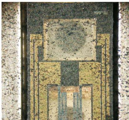
Le sel et la crasse peuvent endommager le capteur d'un débitmètre d'air massique, ou du moins fausser les mesures, ce qui peut également se répercuter sur l'EGR.
