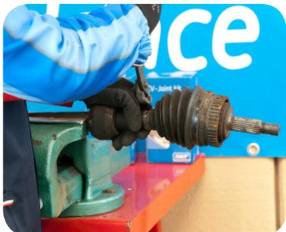
2. Placer l'arbre de transmission dans un étau (doté de mâchoires en aluminium ou de protections). Déposer les deux colliers, interne et externe. Découper le soufflet et le déposer.
