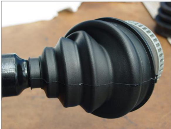
Photo 1 - Serrage incorrect du soufflet
