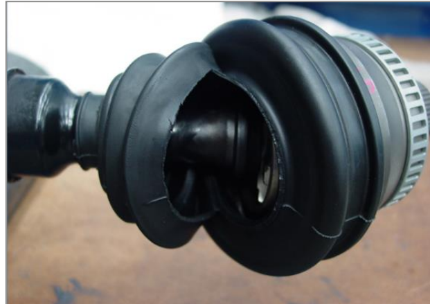
Photo. 2 – Fissure à cause d'un serrage incorrect
