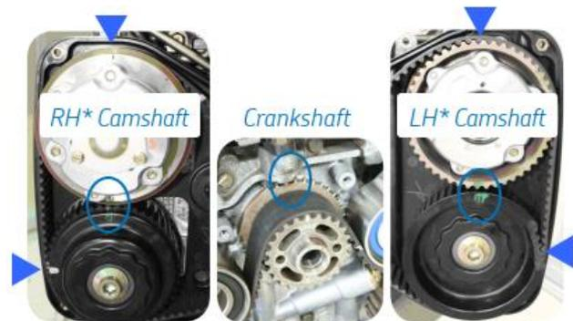
**Remarque :** Une fois l'amortisseur de vilebrequin retiré, utilisez l'outil d'origine Subaru ST499987500 (adaptateur de douille d'entraînement 1/2") pour tourner le vilebrequin.
