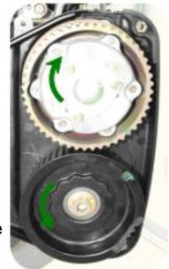
**Attention :** suivre le bon sens de rotation des arbres à cames pour éviter les interférences entre les soupapes du moteur !
