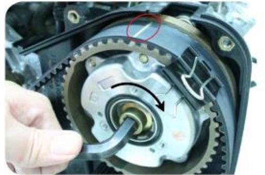
**Image 9 : Fixez la courroie avec une pince-note et aligner la marque de synchronisation**
