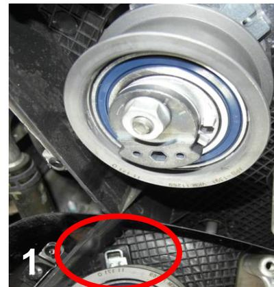
2. Tournez le cadran d'ajustement du tendeur dans le sens des aiguilles d'une montre, jusqu'à ce que l'indicateur soit aligné sur le centre de la plaque arrière (Photo 2).
