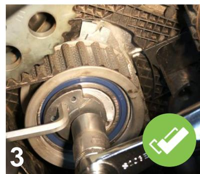
4. Serrez l'écrou du tendeur à **20 Nm + 45°**, en s'assurant du placement correct de l'indicateur sur la plaque arrière (Photo 3).
