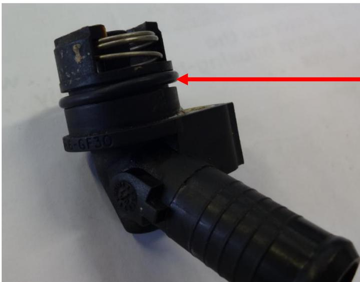
Le joint torique doit être correctement installé pour éviter les contacts et les mauvaises vibrations qui pourraient entraîner des dommages de la pompe à eau et des dégâts de la roue.
