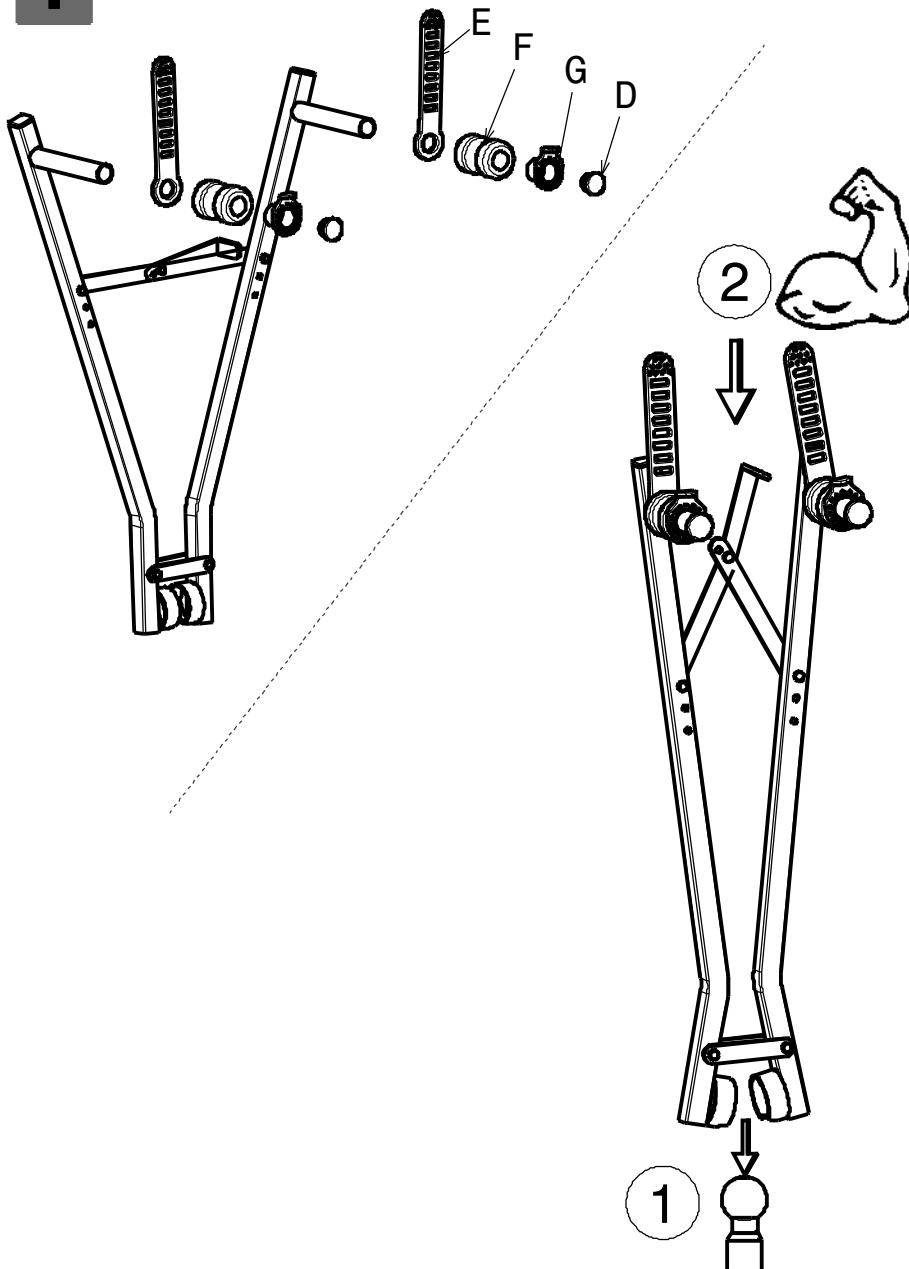
Lors de la première utilisation, il est nécessaire de forcer le verrouillage pour que le porte-vélo se mette en place.
