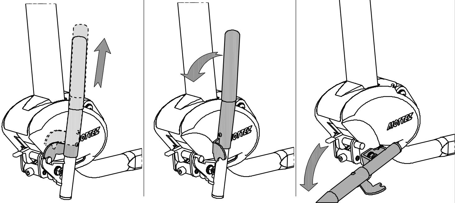
Pour ne pas gêner l'ouverture du coffre vous avez la possibilité de débrayer la poignée. Pour ce faire, levez la partie supérieur de la poignée puis tournez-la dans le sens inverse des aiguilles d'une montre. La poignée peut alors être rabattu et n'agit plus sur le serrage.
