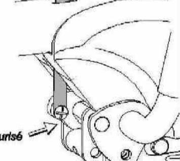
Serrer la vis de réglage manuellement, dans certains cas, le réglage peut être plus dur, le cas échéant utiliser une clé môle 8
