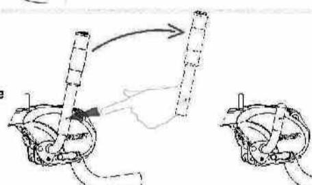
Pour remettre le produit en place, il suffit de basculer l'ensemble jusqu'à sa position initiale
