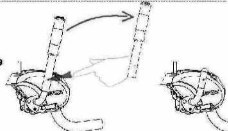
Pour remettre le produit en place, il suffit de basculer l'ensemble jusqu'à sa position initiale
