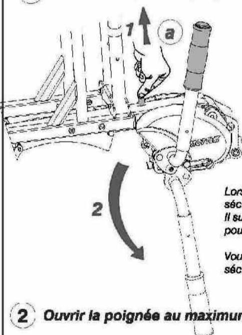
Lorsque la poignée se trouve en position serrée, un loquet de sécurité la verrouille en position.
