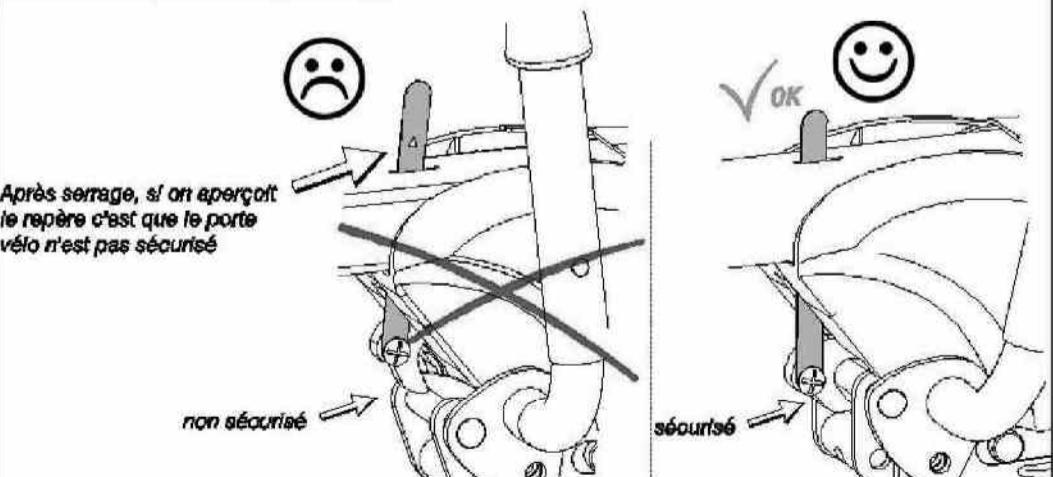
Serrer la vis de réglage manuellement, dans certains cas, le réglage peut être plus dur, le cas échéant utiliser une clé mèche 8.
