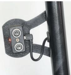
Aucune saisie manuelle, grâce à son sonar, l'EP28 identifie automatiquement les dimensions des roues, détermine le mode d'équilibrage et le type de masse.
