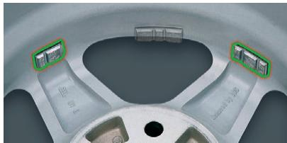
Le mode SPL permet de répartir une masse en deux masses adhésives pour les cacher derrière les bâtons de jante à des fins esthétiques.
