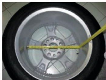
Figure F3.3.1. Exemple de prise de mesure du diamètre externe "da2" pour les programmes ALS1/ALS2
